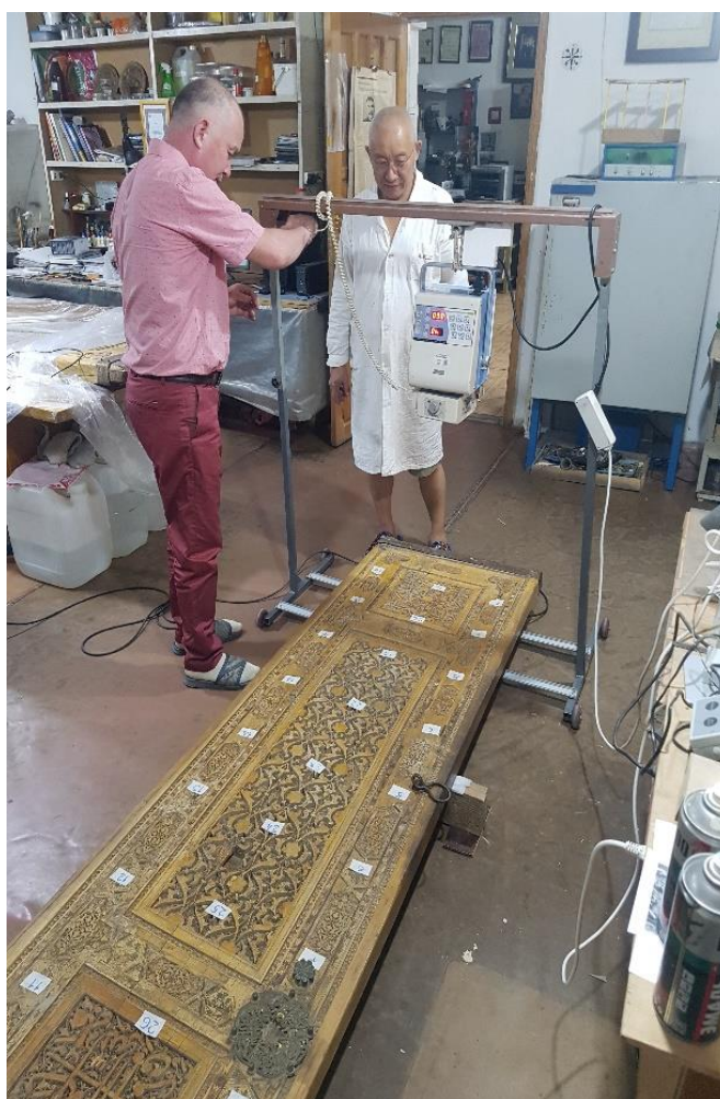
Рисунок 11. Процесс рентгенографического исследования двери в лаборатории.
