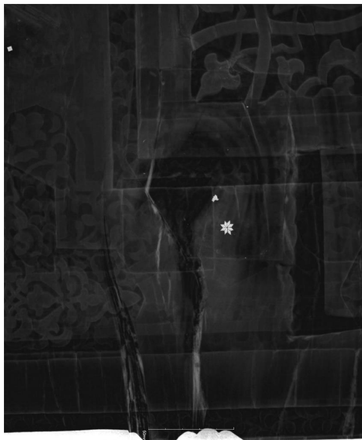
Рисунок 15. На рентгеновском снимке видна полость внутри двери – обозначенная более тёмным цветом.
